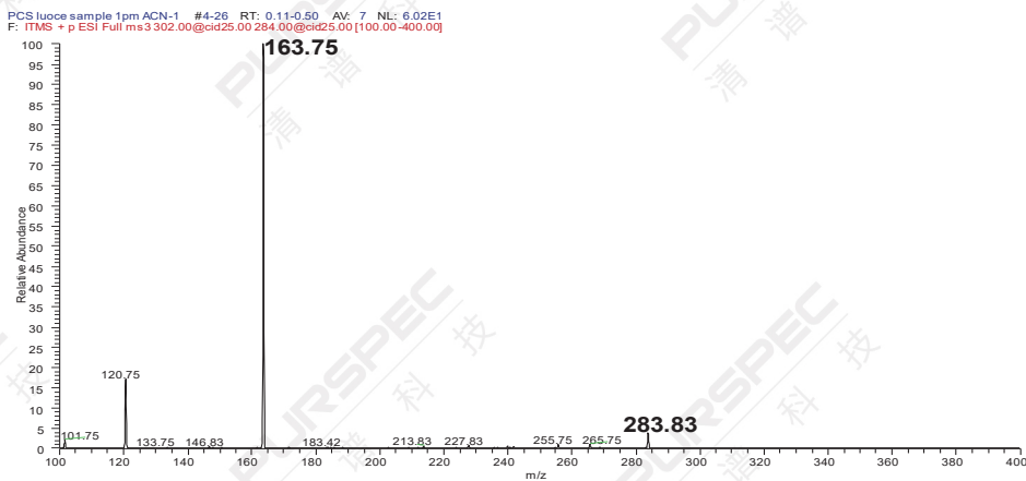
图 2.3 加标饲料中莱克多巴胺(1 \mu g/g)的三级子离子扫描谱图
